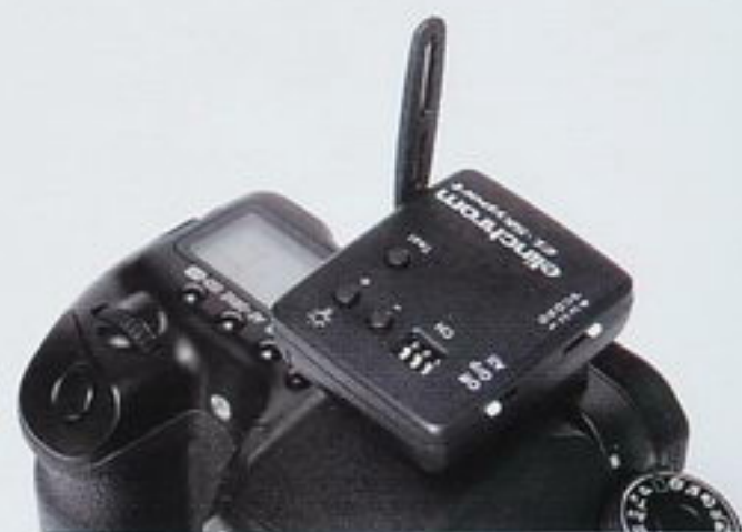
發射器裝在機身的熱靴上，按下快門的瞬間，信號會被送至接收器，再觸動與接收器組合的閃燈。
