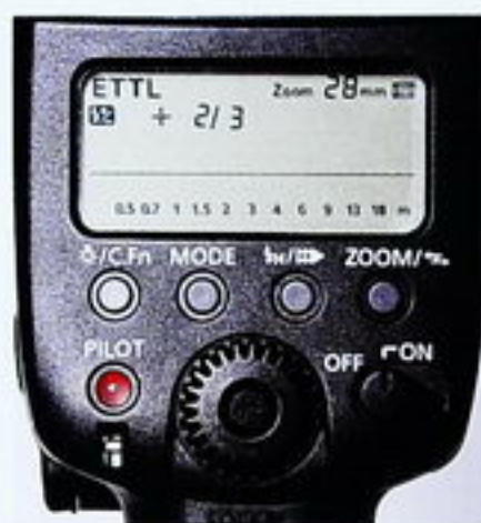
Canon家的580系列閃燈的曝光補償操作，是按一下圓盤中心點，再撥動圓盤的外圈即可調整閃燈的出力大小。
