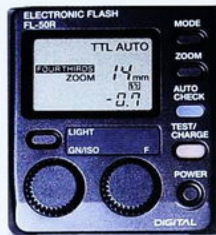
Olympus的FL50R閃燈，使用者在TTL模式之下，撥動雙轉盤的右轉盤，即能進行增或減的曝光補償調整。
