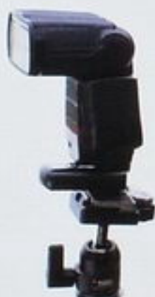
閃燈可以直接裝置於接收器上，而接收器本身附有螺孔，可以裝置於三腳架上，方便架設燈光。
