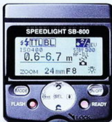
閃燈的曝光補償可以直接在外閃上操作，以Nikon SB 800為例，按壓「+」是正補償，按壓「-」是負補償。
