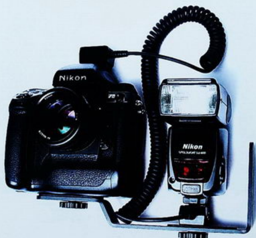
各原廠均有出產俗稱「L架」的設備，讓直幅構圖時的影子減少，但架子本身並不能旋轉。圖為Nikon F5配上SK-E900。
