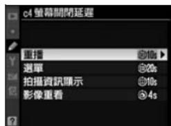
資訊顯示；預設設定為 10 秒）時。為延長電池使用時間，請選擇一個較短的螢幕關閉延遲。當相機由另購的 EH-5a 或 EH-5 AC 變壓器供電時，無論選擇了何種設定，若未對相機執行任何操作，螢幕將保持開啓狀態約 10 分鐘。
