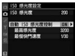
在曝光模式 **P** 與 **A** 下，僅當在 **最慢快門速度**（1/4000 秒至 1 秒）中所選的快門速度下會導致曝光不足時感光度才會被調整。若在 **最高感光度** 中所選的 ISO 感光度值下無法取得最佳曝光，相機可能會使用更慢的快門速度。設定完成後，按下 **OK** 即可退出。
