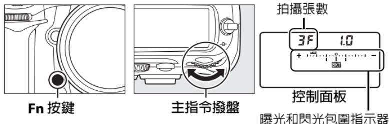
在 0 以外的設定下，控制面板中將顯示 **BKT** 圖示、曝光和閃光包圍指示器，且觀景器和控制面板中將閃爍
