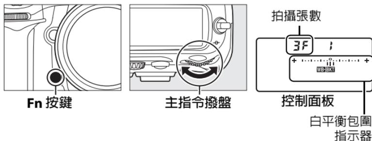
在 0 以外的設定下，控制面板中將出現 **WB-BKT** 圖示和白平衡包圍指示器。
