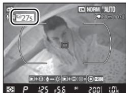
實時顯示期間，相機將在實時顯示開始時顯示所使用的快門速度和光圈。完全按下快門釋放按鍵時，相機將再次測量曝光。
