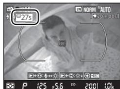
無論選擇哪種測光模式，相機都將使用矩陣測光。相機自動調整快門速度和 ISO 感光度。
