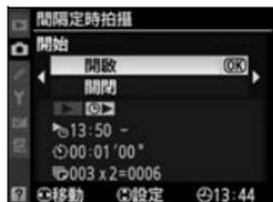
系列的拍攝將在指定開始時間進行, 若在步驟 2 中已將 **選擇開始時間** 設為 **即時**, 第一系列的拍攝則在大約 3 秒後開始。拍攝將按所選間隔時間繼續進行直至完成所有拍攝。請注意, 由於每次拍攝的快門速度和將影像記錄到記憶卡上所需的時間都不同, 記錄拍攝到開始下一次拍攝之間的時間將有所變化。若無法在目前設定下繼續拍攝 (例如, 開始時間短於 1 分鐘, 或者在手動曝光模式下, 目前所選快門速度為 **bulb**), 螢幕中將出現警告資訊。
